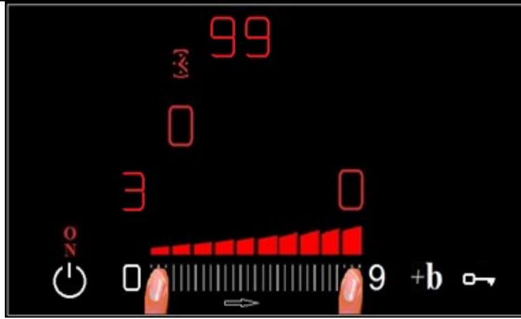
Hình 16: Giá trị thời gian hẹn hàng chục được chọn từ 0-9 phút.
