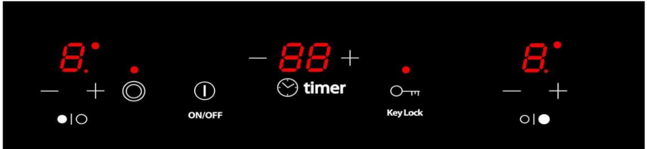
Hình 1: Cấu tạo bàn phím điều khiển
