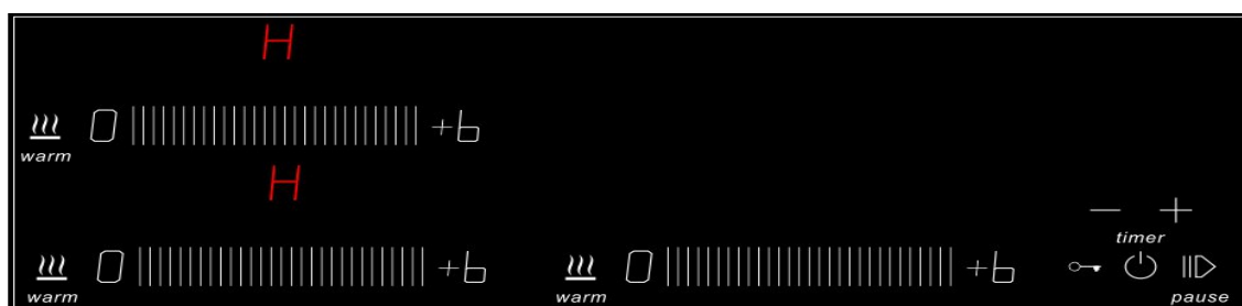
Hình 18: Cảnh báo nhiệt dư 2 vùng nấu bên trái.
