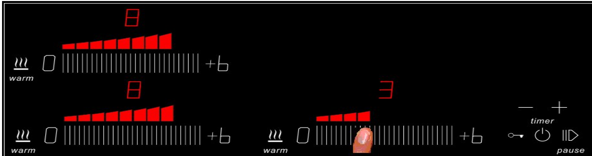
Hình 10: Kích hoạt chế độ nấu thông minh tại mức 3 bằng cách chạm và giữ tay ở vị trí mức 3 trong 2,5 giây.
