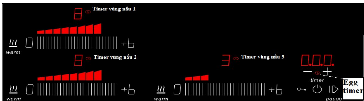
Hình 15: Bộ hẹn giờ độc lập cho từng vùng nấu của bếp.
